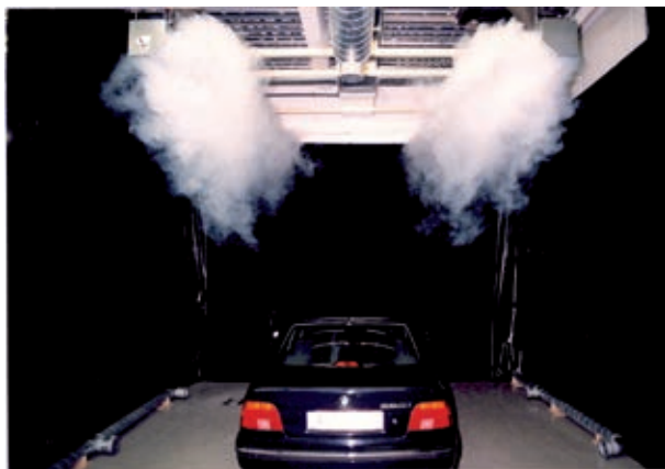
Bild 7: Halbtrapezförmiger Verdrängungsauslass in einem Versuchsraum der Automobilindustrie
