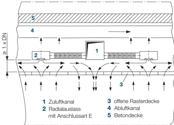
Anordnung von Radialauslässen oberhalb einer offenen Rasterdecke. Die Abluft wird gleichmäßig über die ganze Decke abgeführt und in einen Abluftkanal, unmittelbar über den Radialauslässen, abgesaugt.
