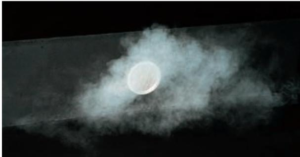
**Bild 7: Strahlusbildung durch Rauchprobe sichtbar, oben: Linearer Stufenquellauslass unten: Runder Stufenquellauslass**
