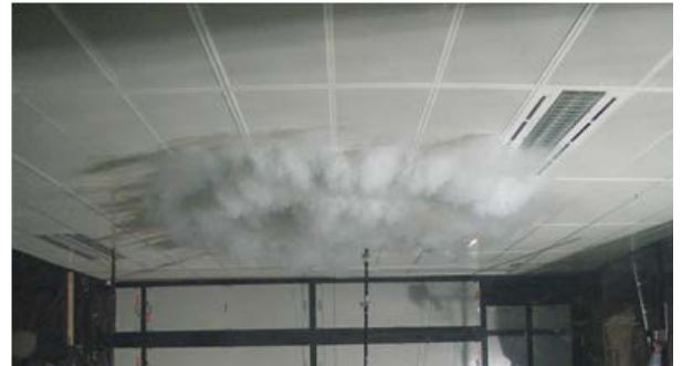
Bild 1: Strömungsbild mittels Rauch sichtbar gemacht
