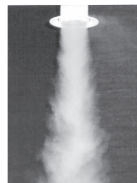
Strahlausbreitung durch Rauchprobe sichtbar gemacht, oben, Kühlfallstellung: die horizontal ausgeblasene kühle Zuluft strömt gleichmäßig langsam nach unten, unten, Heizfallstellung: die warmen, vertikalen Zuluftstrahlen dringen tief in den Aufenthaltsbereich ein, links: mit Leitring, rechts: mit Strahlrichter
