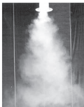
Strahlausbreitung durch Rauchprobe sichtbar gemacht, oben, Kühlfallstellung: die horizontal ausgeblasene kühle Zuluft strömt gleichmäßig langsam nach unten, unten, Heizfallstellung: die warmen, vertikalen Zuluftstrahlen dringen tief in den Aufenthaltsbereich ein, links: mit Leitring, rechts: mit Strahlrichter
