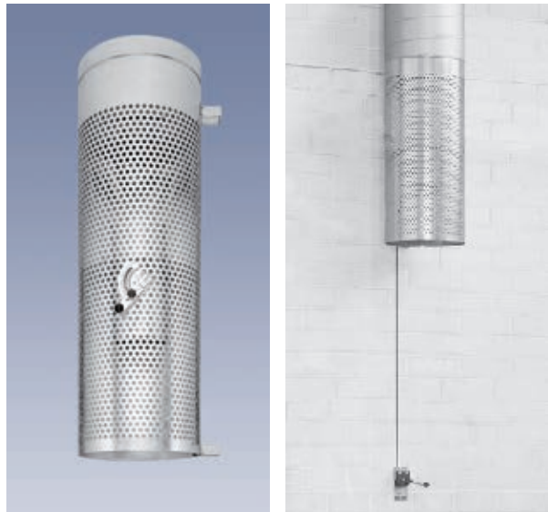
Bild 2: Runder Verdrängungsauslass mit Drehklappe links: Verstellung mit Stellhebel rechts: Verstellung mit Bowdenzug
