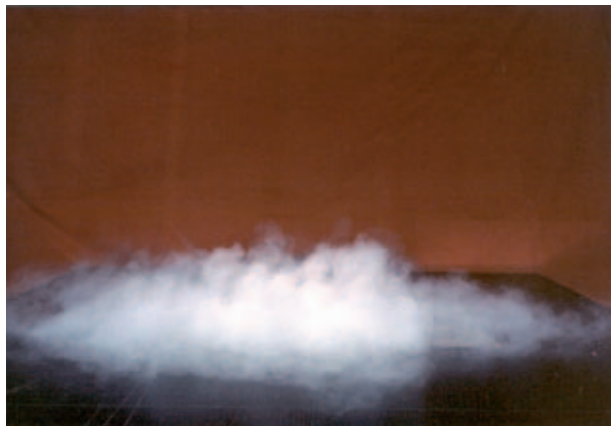
Bild 4: Turbulenzarme horizontale, radiale Strahlausbreitung, durch Rauchprobe sichtbar
