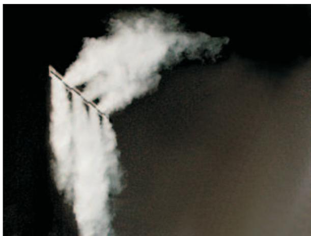
**Bild 4: Luftstrahlusbildung durch Rauchprobe sichtbar gemacht**
