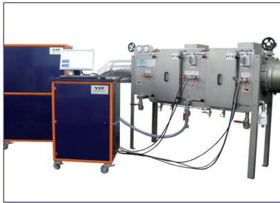
Automatische scanner met premixbox, Aërosolproductie, 2 stuks OPC en computer
