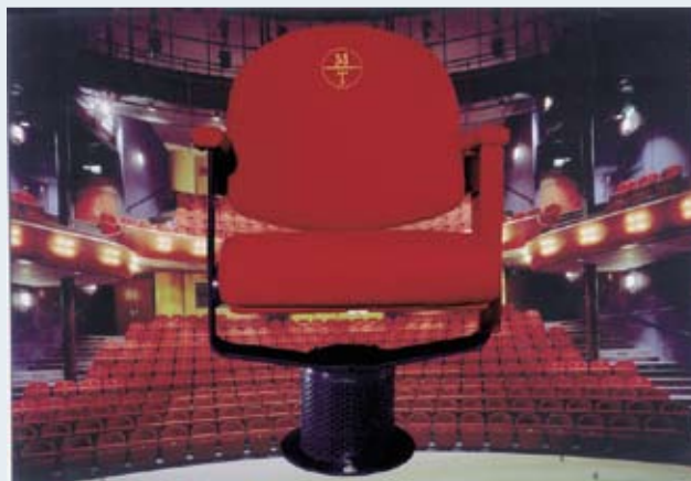
Voor het Munttheater in Weert maakte Peek het onderstel voor de stoelen. De poot bestaat uit een geperforeerde binnen- en buiten-cilinder waar gekoelde toevoerlucht doorheen stroomt.
