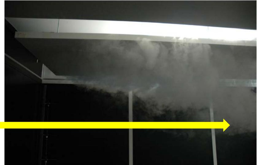
Bild 13: Ansicht 2 der Strömungsvisualisierung bei 100 m<sup>3</sup>/h,  $\Delta T_L = -6$  K in Ausführung B
