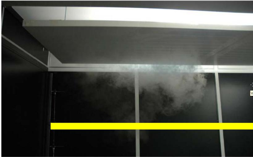
Bild 9: Ansicht 2 der Strömungsvisualisierung bei 50 m<sup>3</sup>/h,  $\Delta T_L = -6$  K in Ausführung B
