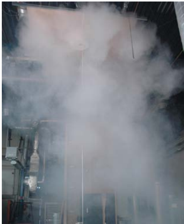
Bild 6: Kühlfall mit Luftdurchlass-Volumenstrom 2 500 m 3 /h und \Delta\vartheta_K von -5 K aus 8,2 m Höhe
