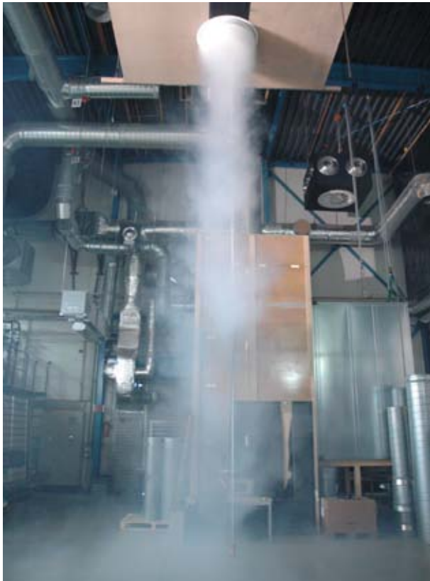
Bild 4: Heizfall mit Luftdurchlass-Volumenstrom 2 500 m 3 /h und \Delta\vartheta_H von +8 K aus 8,2 m Höhe
