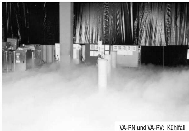
Bild 4: Ausbreitung der Luftstrahlen durch Rauchprobe sichtbar
