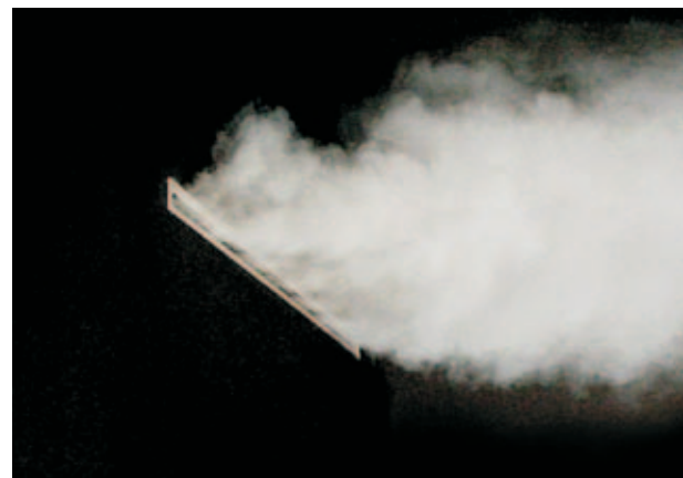
Bild 4: Luftstrahlusbildung durch Rauchprobe sichtbar gemacht oben: schräg nach oben und nach unten rechts: horizontal
