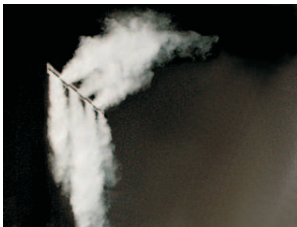
Bild 4: Luftstrahlusbildung durch Rauchprobe sichtbar gemacht oben: schräg nach oben und nach unten rechts: horizontal
