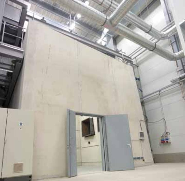
Der Hallraum – 200 m<sup>3</sup> stahlgedeckte Laborumgebung
