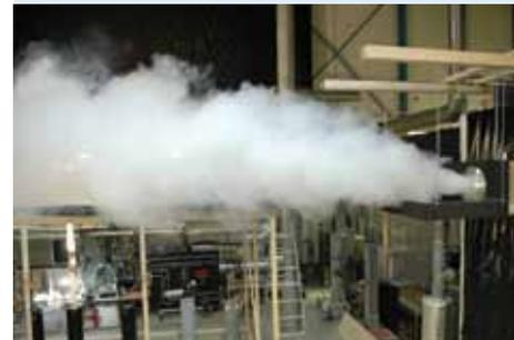
Klimatisierung durch Weitwurf-düsen für Flughafenterminals
