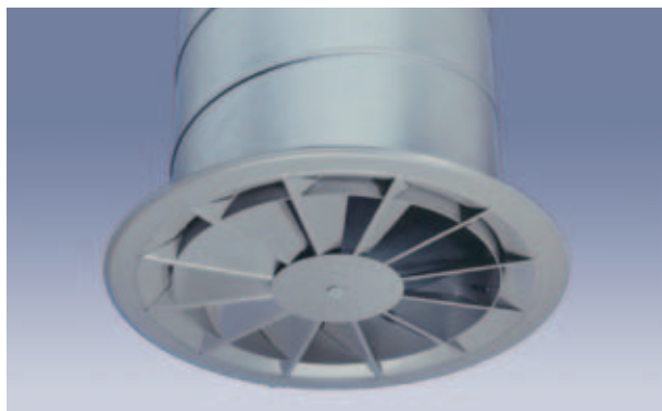
Bild 1: Verstellbarer Radialauslass mit runder Sichtfläche, oben: Leitring "eingefahren", Kühlfall unten: Leitring "herausgefahren", Heizfall
