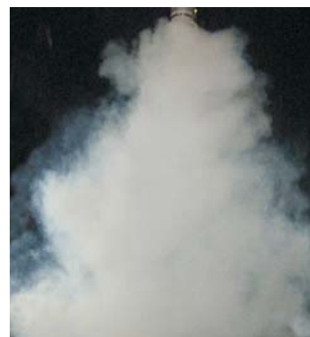
Luftstrahlausbildung RA-V2 oben: Kühl- und Heizfall unten: Heizfall
