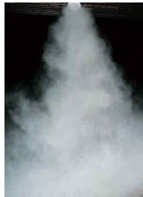
Luftstrahlausbildung RA-V unten: horizontale Strahlrichtung (Kühlfall) links: vertikale Strahlrichtung (Heizfall)
