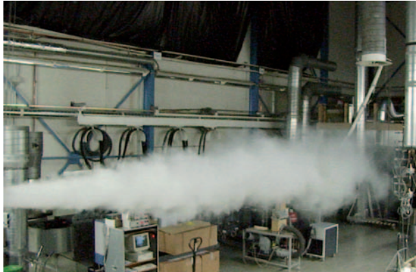
Bild 3: Strahlausbreitung der Weitwurfdüse
