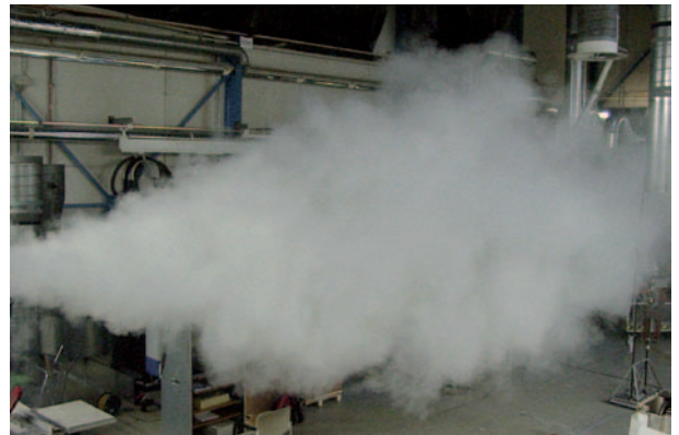
Bild 4: Strahlausbreitung der Dralldüse
