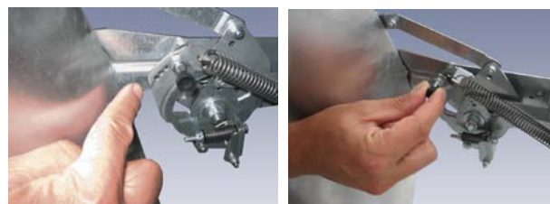
Bild 12: Nachträgliche Verstellung des Ausblaswinkels in 5^\circ -Schritten, insgesamt um 20^\circ
